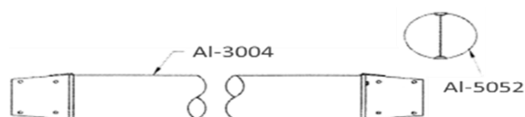
Figura 1. Esquema de flotador.
